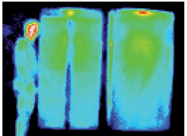
**Fazit:** Die Homebox Classic Silver Line weist bei funktionierender und adäquater Abluftanlage keine signifikante Wärmeabgabe auf. Der einzige erkennbare Punkt wäre die Austrittsöffnung der Abluftanlage, sofern diese an der Außenwand des Gebäudes angebracht ist.
